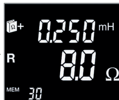
Schermata 3: valore dell'impedenza dell'anello di terra
